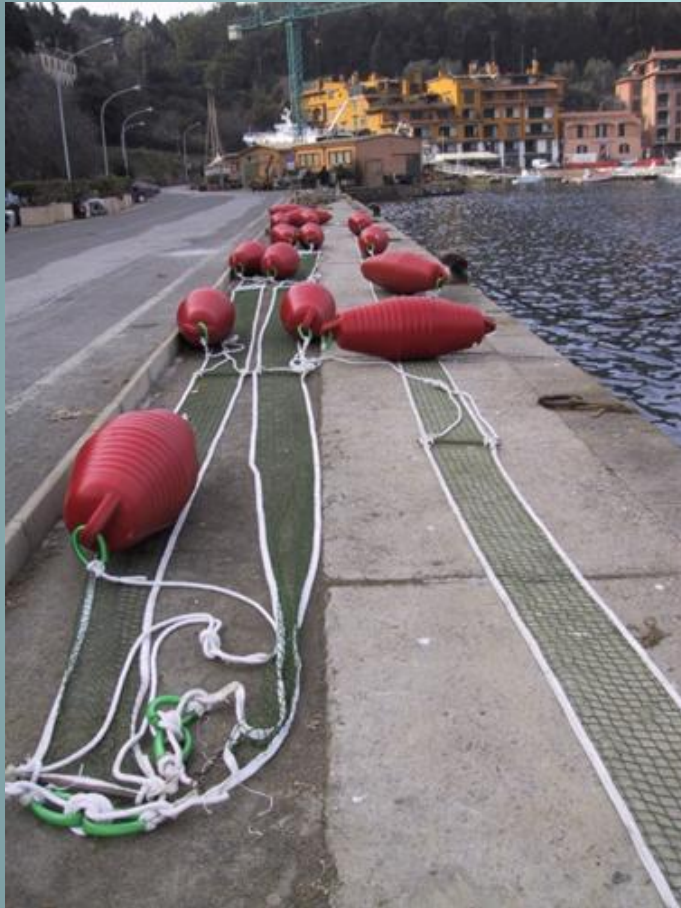
Pannelli in rete pronti per essere installati sui long line
