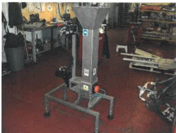
Figura 2 – A sinistra, il modello di tritatore già usato per gusci di molluschi (cozze e ostriche), che ha fornito la base di sviluppo per il prototipo del sistema trita-rete. A destra, il prototipo in funzione con uno spezzone di calza per mitilicoltura preso così come uscito dalla sgranatrice.
