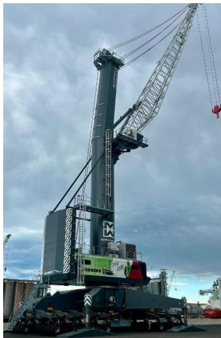
La gru portuale mobile Liebherr, tipo LHM 600
